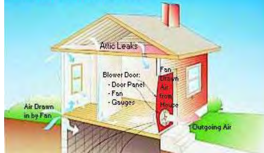
Blower Door Depressurization Test
